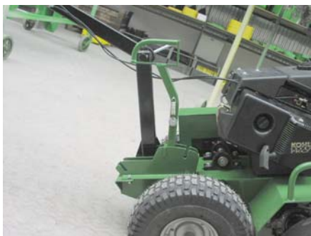
Leva posta in posizione DOWN I
