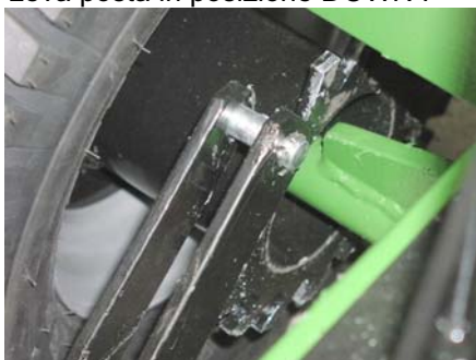
Vista della ruota di lavoro bloccata in posizione DOWN
