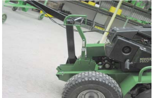
Leva regolazione profondità in posizione "DOWN I"
